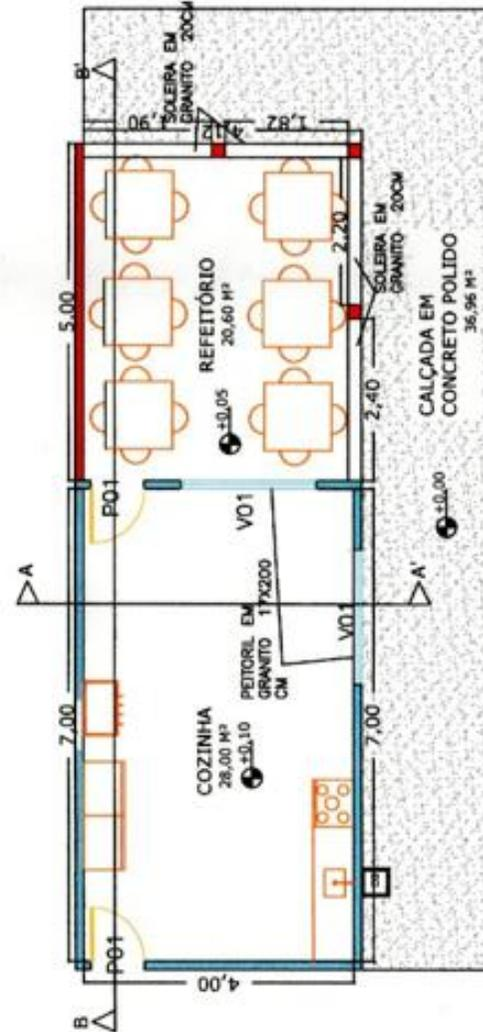
PLANTA BAIXA A CONSTRUIR E REFORMAR ESC: 1:100
